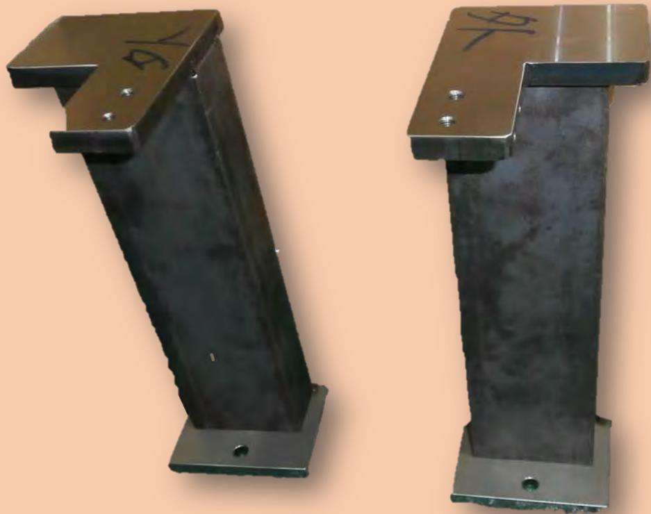
レーザー切断→溶接→フライス加工
