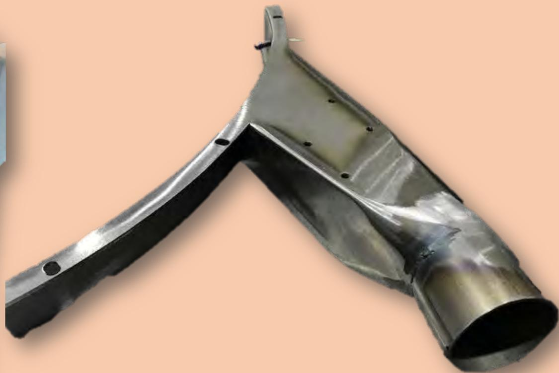
レーザー切断→曲げ→溶接 SUS304 2t
