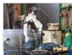
ロボット溶接
